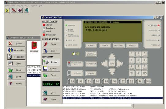
La connexion entre le programme Telecontrol et les échanges peut être établie via des interfaces série (RS-232, RS-485) ou via TCP / IP.
